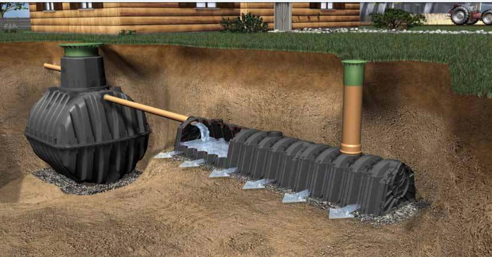
¿No hay ningún río o zona para evacuar el agua depurada cerca de su casa? Entonces puede infiltrar el agua depurada en el subsuelo utilizando el Túnel de Drenaje GRAF. Sólo necesita un terreno suficientemente permeable a una distancia mínima de 80cm de los niveles freáticos.
